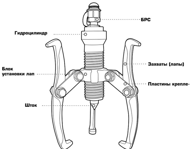
Съемник гидравлический состоит из корпуса гидроцилиндра, упорного штока, захватов (лап) и быстроразъемного соединения (БРС). Внешний насос подключается к съемнику с помощью рукава высокого давления через БРС. Подача рабочей жидкости в полость гидроцилиндра съемника под давлением происходит за счет приведения в работу внешнего гидравлического насоса.
